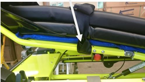
Beckengurt: An der Gurthaltung unter dem Fahrtragen-Rahmen mit einer Schlaufe
