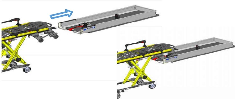
Die SILVER bis zum Anschlag in die Schienenführung einfahren. Hierbei ist zu beachten, dass alle 4 Auffahräder sicher auf der Schiene aufsitzen und die Trage einrastet. Nun wird die Trage vom Tisch gehalten und Sie können die Beine hochfahren.
