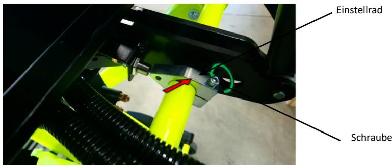
Halten Sie die Trage in dieser Position und ziehen Sie sie wieder aus der Führung. Danach schauen Sie auf das Einstellrad, das sich unter dem Rückenteil an der Trage befindet. Das Einstellrad ist verbunden mit der Achse mittels einer Schraube die Sie nun lösen müssen. Nun drehen Sie das Einstellrad bis der Näherungsschalter aufleuchtet. Jetzt stellen Sie die Schraube wieder fest, um die Trage in dieser Position zu justieren.
